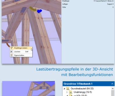
Lastübertragungspfeile in der 3D-Ansicht mit Bearbeitungsfunktionen
