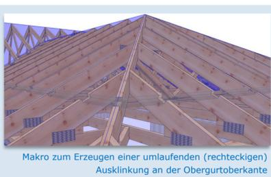
Makro zum Erzeugen einer umlaufenden (rechteckigen) Ausklinkung an der Obergrupertoberkante
