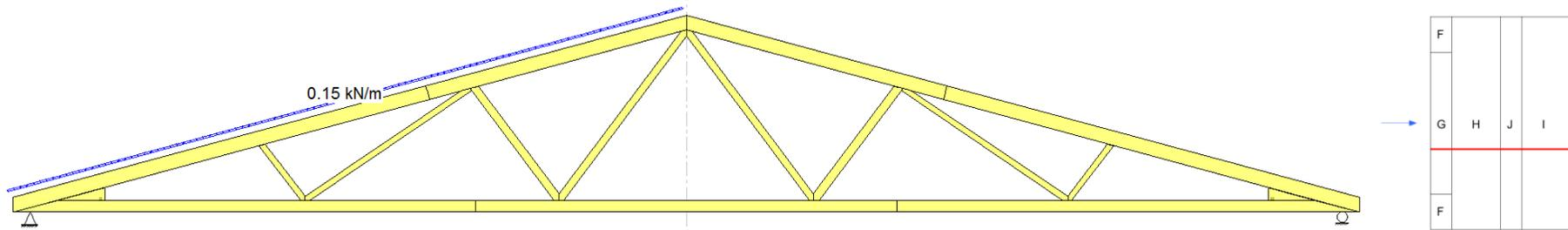
**Fall 1 – (Giebelbereich<sup>1</sup>): „Wind von links, max-max“ = „Wind von links – max“**
