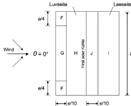
**Fall 1 – (Normalbereich): „Wind von links, max-max“ = „Wind von links – max“**
